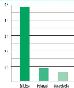
Verzögerter Durchgang von Sonnenwärme (= Phasenverschiebung/PHI) bei Dämmstoffen in Stunden.
